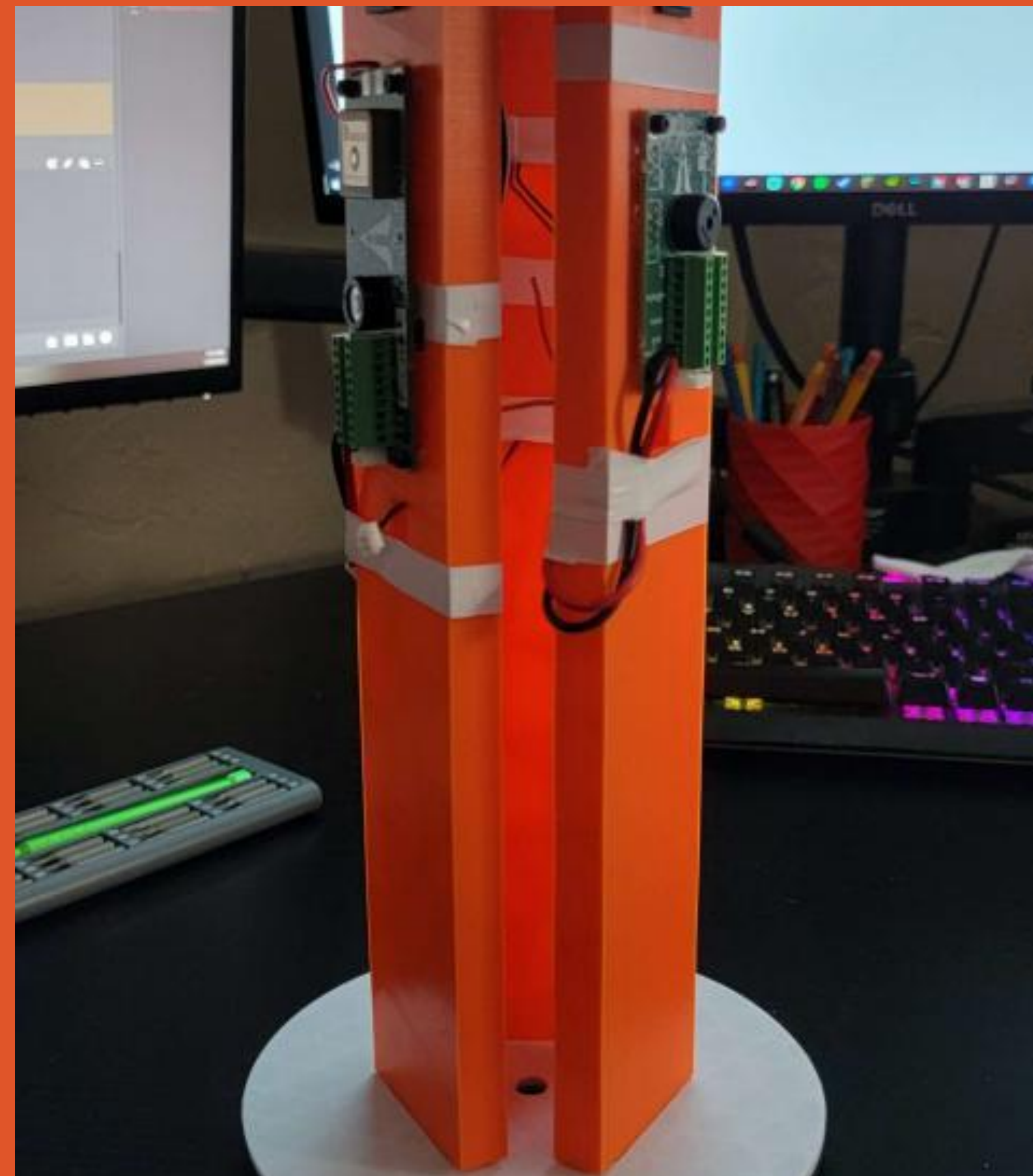
AV Bay with attached electronics
